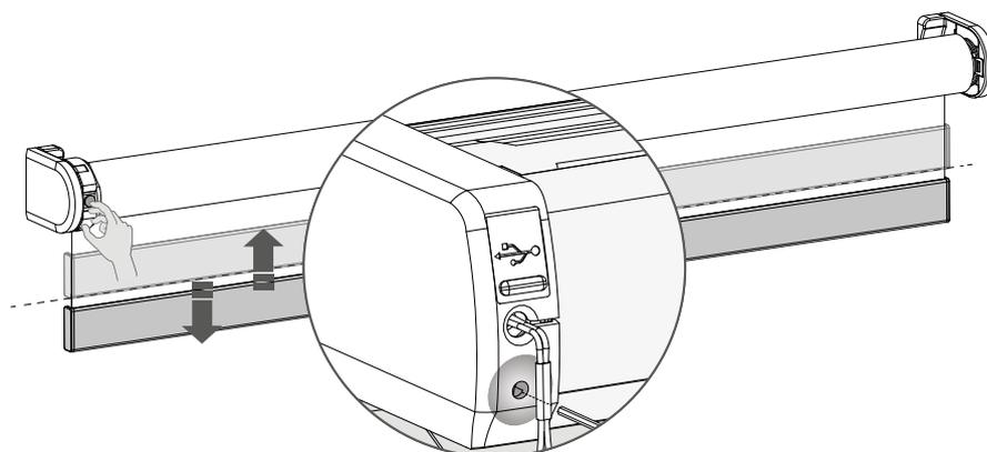
**14.1** Premi rapidamente il tasto di programmazione del motore. La tenda inizierà a muoversi Su e Giù, indicando che il motore è entrato nello stato di programmazione.
