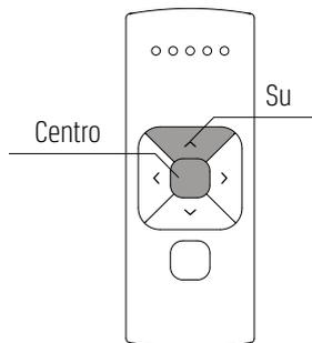
**6.1** Simultaneamente premi il tasto Stop e Su. La tenda si fermerà brevemente di muoversi indicando che il limite della posizione inferiore è stato salvato.
