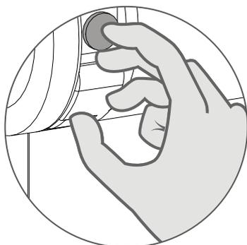
**10.1** Premi brevemente il tasto di programmazione sul motore. La tenda si fermerà per indicare l'uscita dallo stato di programmazione e si potrà comandare con il telecomando accoppiato.
